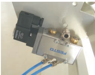
Pneumatisches Elektromagnetventil FESTO Pneumatic electrovalve FESTO Elettrovalvola pneumatica FESTO
